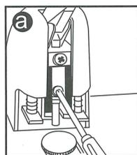
Para cambiar de cortador, afloje el tornillo hasta que el cortador caiga. Empuja el cortador de repuesto lo alto posible, para luego apretar el tornillo.
