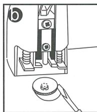
Le da vuelta a los discos plásticos regularmente. Los discos serán cambiados fácilmente. (KW-952-DISC)
